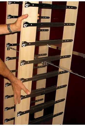
Schiebe die Doppelleitern zwischen die Stäbe und befestige sie an den Stäben. Die Stangen gegen die Rückwand schrauben, Schrauben 4,2x13.
